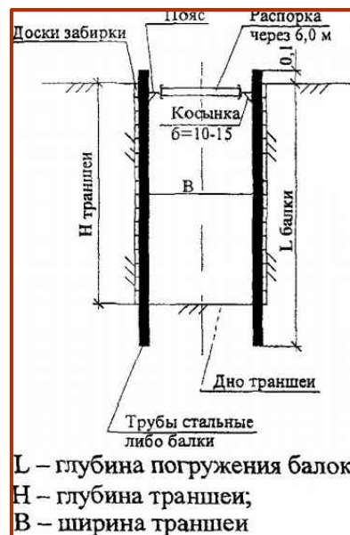
Пример крепления стенок котлована
